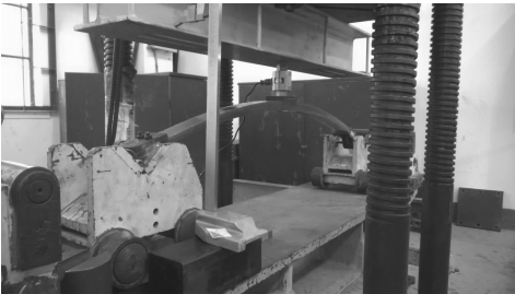
图 7 复合材料板簧的台架试验
